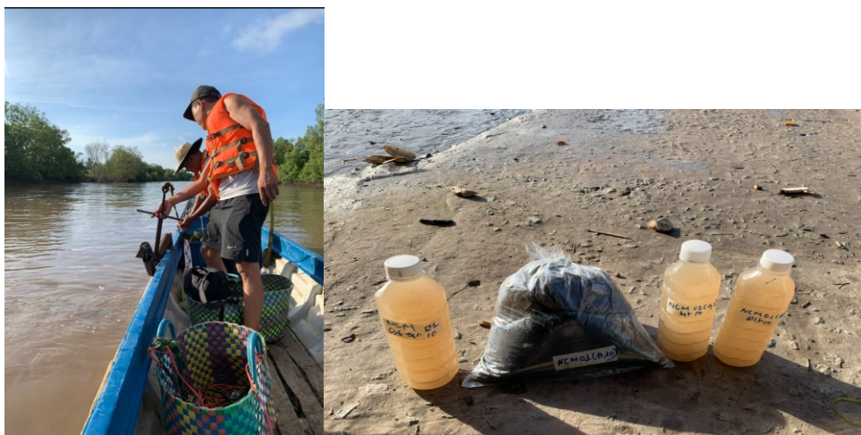
Hình ảnh lấy mẫu phù sa lơ lửng đáy tại trạm NCM- 01
