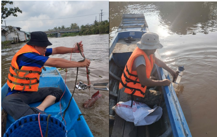
Hình ảnh đo lưu tốc dòng chảy và lấy mẫu phù sa lơ lửng tại trạm QLPH- 06
