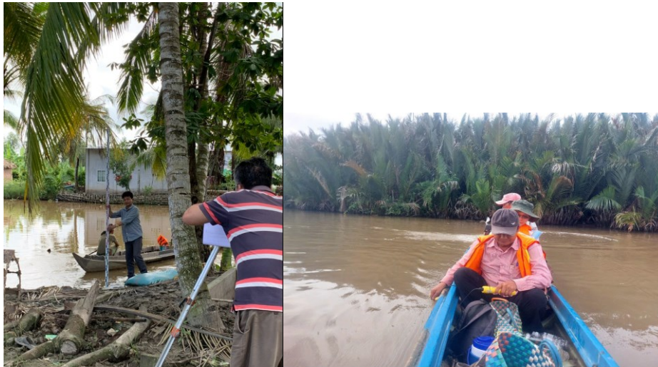
Hình ảnh dẫn độ cao tại trạm QLPH-04 và đo mặt cắt ngang tại trạm NCM 03
