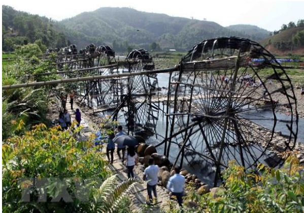
Hình 7: Ứng dụng “Guồng quay nước” để vận chuyển nước tưới từ sông, suối lên tưới ruộng lúa, hoa màu trên cao ở khu vực trung du, miền núi
